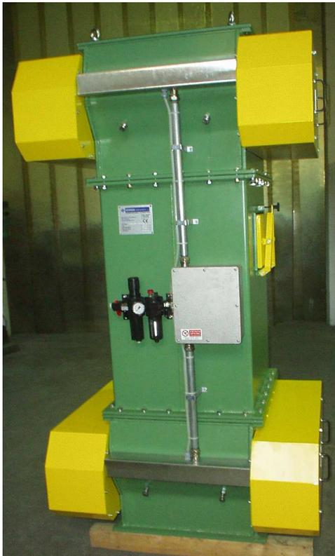
**Figura 1: Tipo CL600 a comando pneumatico**
